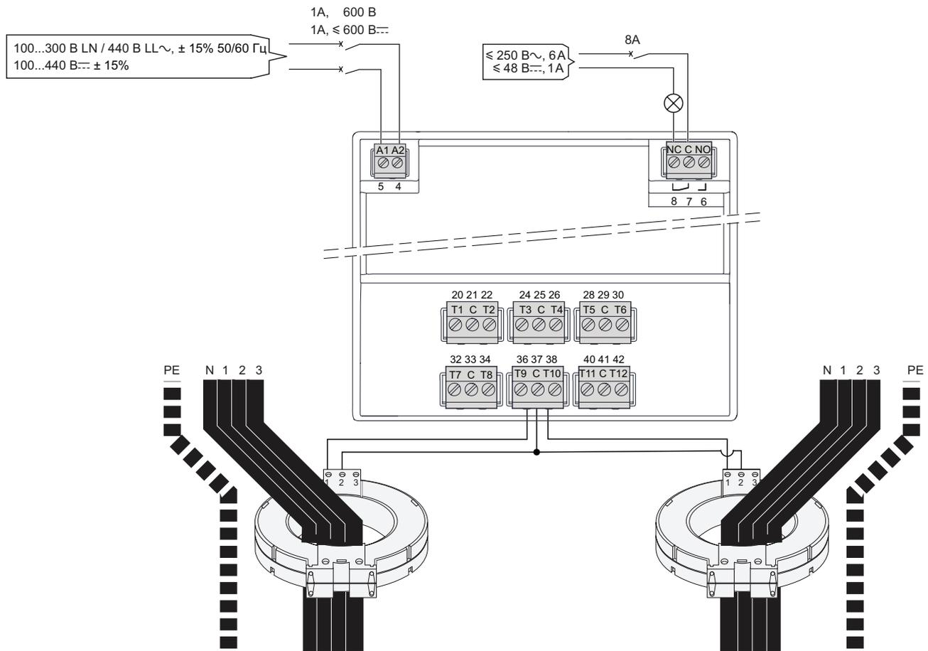
**Примечание.** Приведен пример подключения тороидальных трансформаторов к Т9 и Т10. Используйте такое же подключение для других тороидальных трансформаторов.
