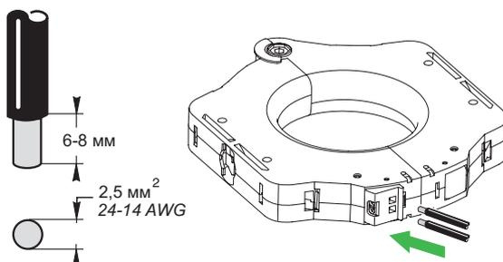
Клемма 3 не используется для подключения тороидального трансформатора
