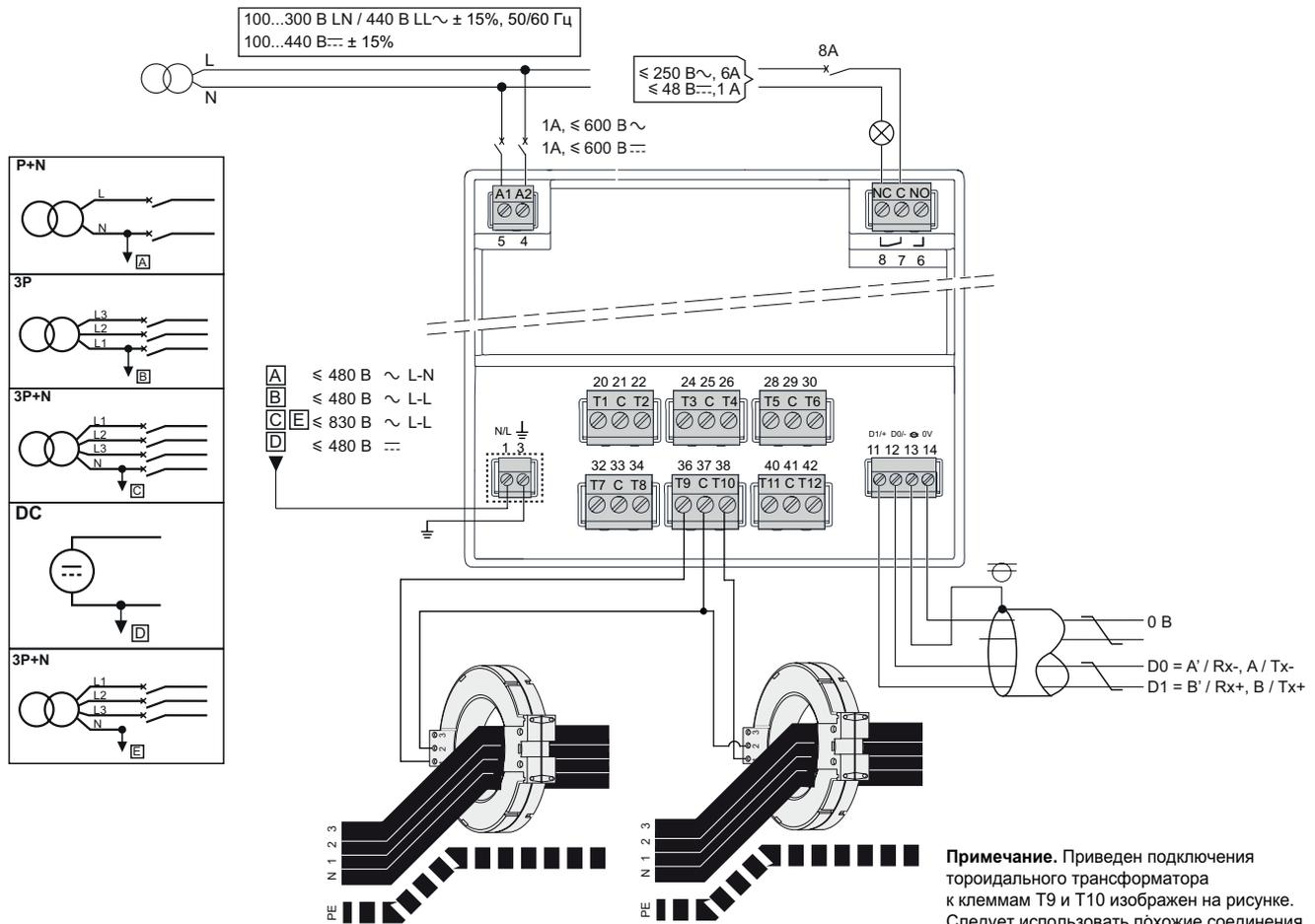
**Примечание.** Приведен подключения тороидального трансформатора к клеммам T9 и T10 изображен на рисунке. Следует использовать похожие соединения для других тороидальных трансформаторов.
