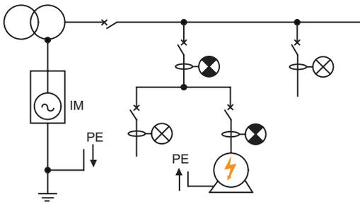
Устройство контроля сопротивления изоляции обнаруживает и сигнализирует о неисправности изоляции в зависимости от заданного порогового значения. Устройство активирует реле сигнализации, которое можно подключить к звуковым или световым индикаторам. Сигнал о неисправности также может быть отправлен через канал связи.
