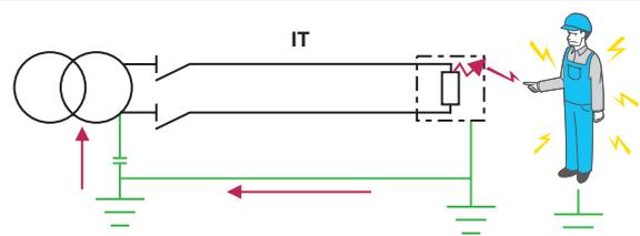
В случае первого пробоя ток неисправности может проходить через емкость утечки IT-сети
