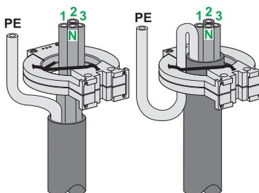
Использование с локализатором повреждения изоляции VigiloHm:
