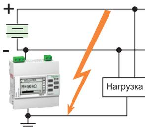
Устройство контроля сопротивления изоляции подключается к одной полярности. Если сеть включает аккумуляторы или батареи, сигнал проходит по обеим полярностям, что позволяет обнаружить пробой изоляции, затрагивающий любую часть сети
