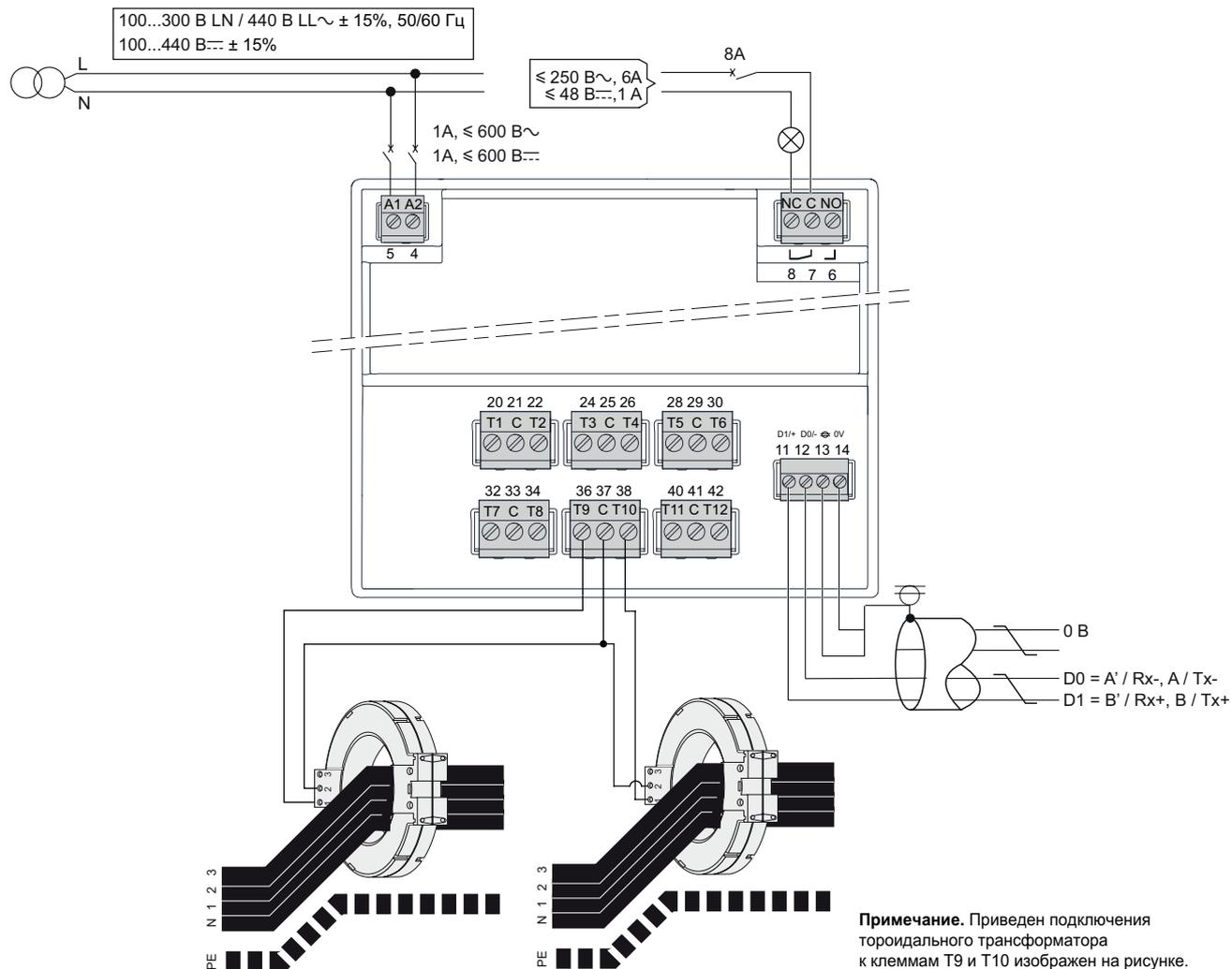
**Примечание.** Приведен подключения тороидального трансформатора к клеммам T9 и T10 изображен на рисунке. Следует использовать похожие соединения для других тороидальных трансформаторов.
