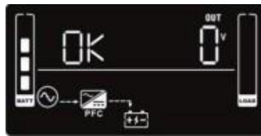
Рис.1 Отображение режима ожидания на дисплее ИБП SRT
