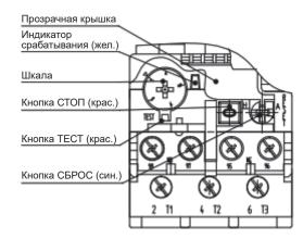
Рис. 4. Детали теплового реле
