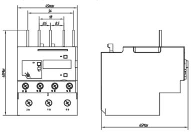
Рис. 2. Габаритные и установочные размеры
