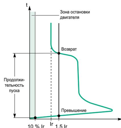
Пуск электродвигателя и затынутый пуск
