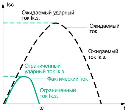
Автоматические выключатели SystemePact обеспечивают исключительное токоограничение благодаря технологии ротоактивного размыкания: быстрое естественное отталкивание контактов и введение в цепь короткого замыкания двух последовательных падений напряжений на электрической дуге с очень крутым фронтом
