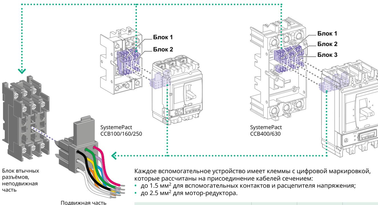
Каждое вспомогательное устройство имеет клеммы с цифровой маркировкой, которые рассчитаны на присоединение кабелей сечением:
