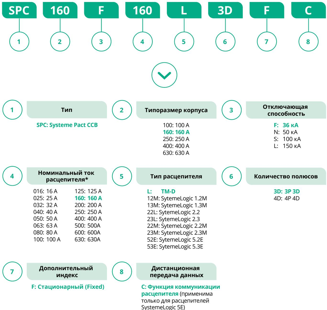
Например, автоматический выключатель в литом корпусе серии SystemePact CCB на номинальный ток 160 А, в исполнении F (36 кА), трехполюсный, с расцепителем TM-D на 160 А, стационарный, будет иметь каталожный номер **SPC160F160L3DF**.
