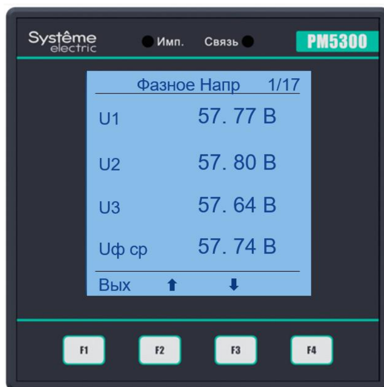
Рисунок 4.1 Передняя панель счётчика PM5300
